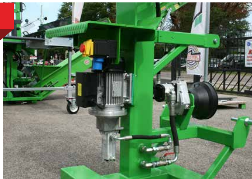
Doppio azionamento elettrico + cardano
