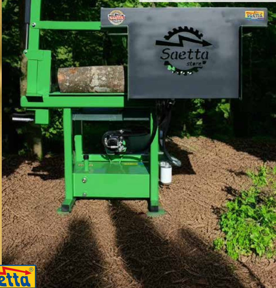
Avvio solo con carter chiuso per la massima sicurezza
