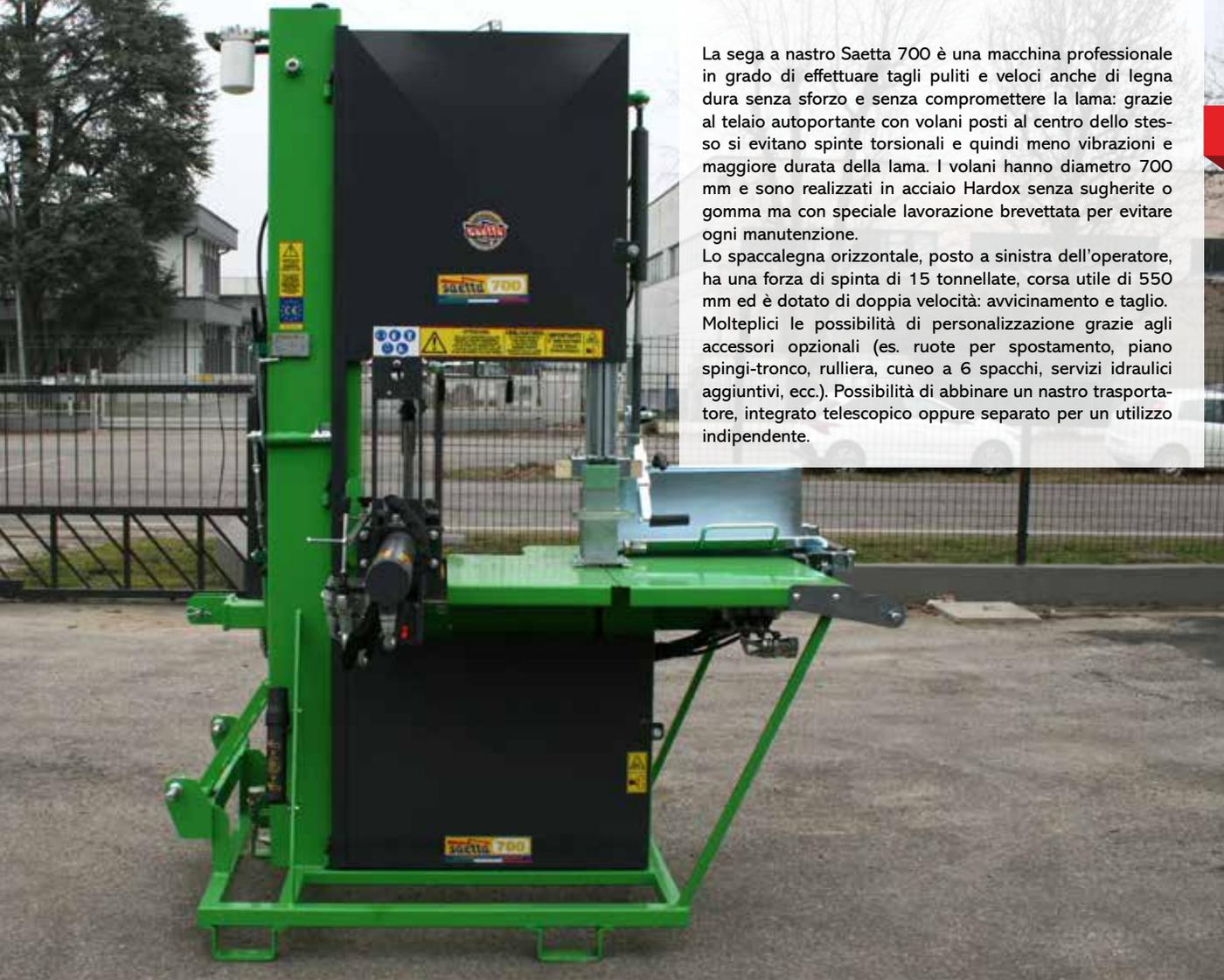
La sega a nastro Sietta 700 è una macchina professionale in grado di effettuare tagli puliti e veloci anche di legna dura senza sforzo e senza compromettere la lama: grazie al telaio autoportante con volani posti al centro dello stesso si evitano spinte torsionali e quindi meno vibrazioni e maggiore durata della lama. I volani hanno diametro 700 mm e sono realizzati in acciaio Hardox senza sugherite o gomma ma con speciale lavorazione brevettata per evitare ogni manutenzione.
